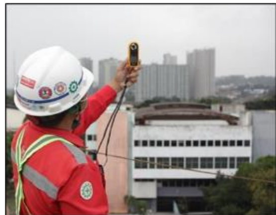
Gambar 12. Pengecekan Kecepatan Angin dengan Anemometer
