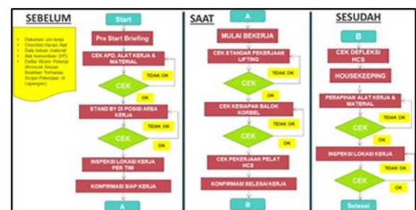
Gambar 6. Flowchart Pekerjaan Connecting Tower Menggunakan Metode HCS
