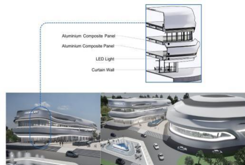
Gambar 13. Fasad Bangunan Sumber: Penulis, 2025
