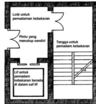
Gambar 2. Persyaratan shaft kebakaran (Permen PU No.26/PRT/M tahun 2008.)
